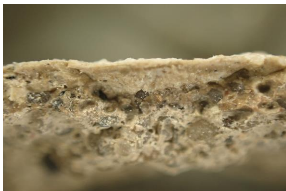
fot. 1. Przekrój warstwy powierzchniowej tynku
